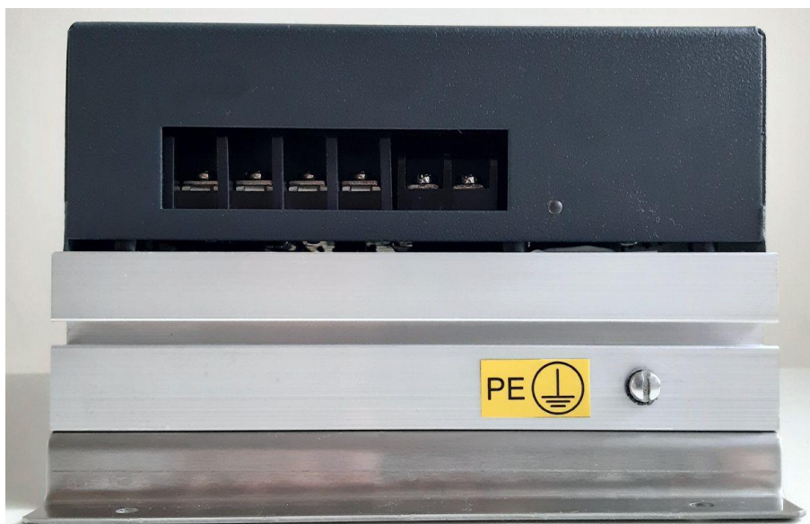
Slika 4.14 Pozicija vijka za povezivanje uzemljenja
